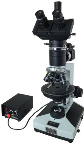
Incluye: Extra 10x Ocular con una función de medición del retículo: X-Scale, 10 mm en 100 divisiones, 0.1mm Resolución.
